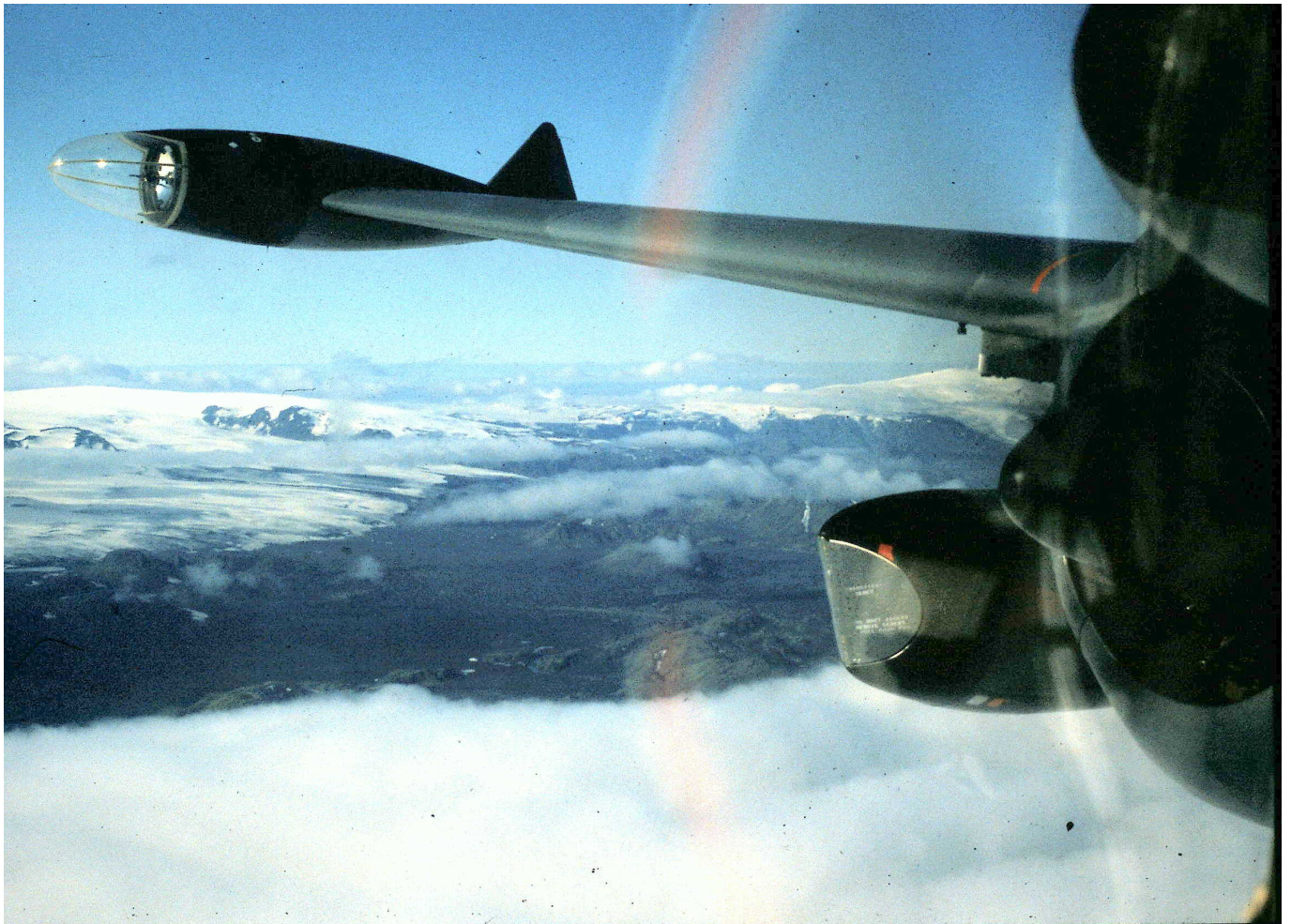
Stuurboord tiptank met zoeklicht.
